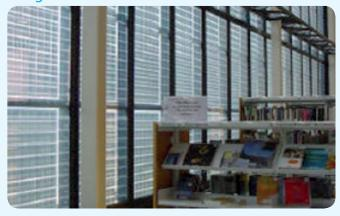
La biblioteca Pompeu Fabra de Mataró fue diseñada con una doble finalidad, la generación de energía FV y energía térmica, además de asegurar el máximo confort. La instalación consiste en un muro cortina basado en células solares de silicio policristalino, de manera que se asegura la luz natural en el interior de la biblioteca.
